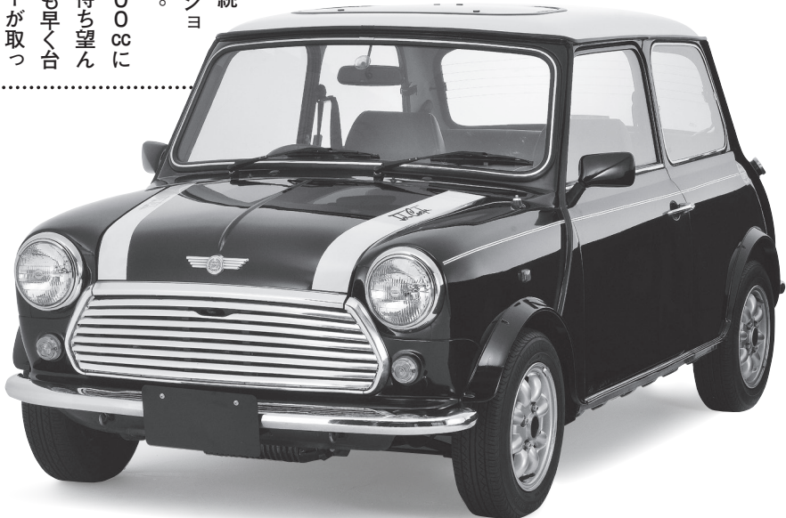
限定販売されたモデルはボンネットストライプやサンルーフ、赤いレザー巻きのステアリングホイール、オイルクーラーなどが標準で装備されていた。限定車のエアダクトはつるんとしているが、カタログモデルにはエンボスのクーパーマークが付く
